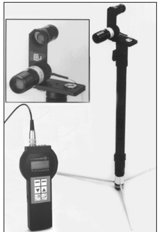
Bild 5: Leuchtdichtemessung mit Leuchtdichte-Vorsatz und Visiereinrichtung
