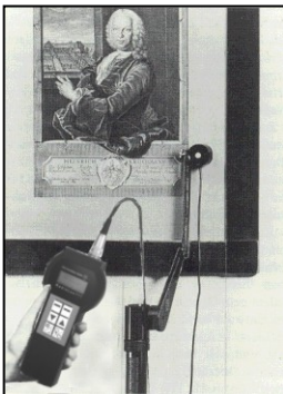
Bild 4: Museumsadapter mit Stativ für die Messung auf beliebig geeigneten Exponaten oder Raumbegrenzungsflächen
